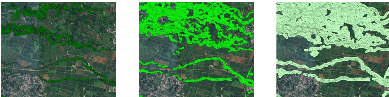
Figure 28 : Extraits des aléas Glissements de terrain Fort (à gauche), Moyen (au centre) et Faible (à droite) nettoyés, lissés et avec tampons sur la commune de Capesterre-Belle-Eau [Source : Ginger CEBTP]
