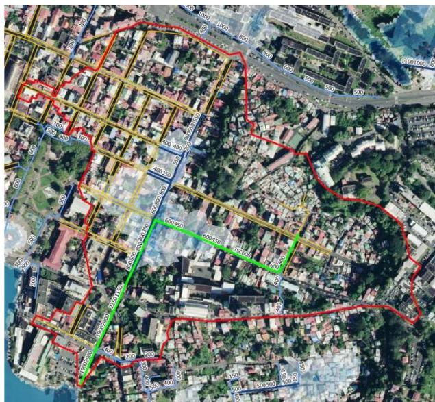
Figure 78 - Linéaire hydrocuré en août 2021 (en vert) et photographies de l'opération d'hydrocurage d'août 2021
